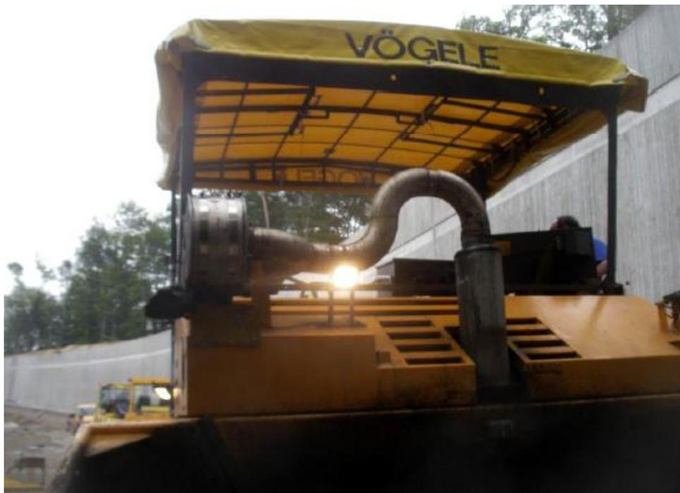
Obwohl die Luft im Tunnel stand - zwei Lüfter arbeiteten entgegengesetzt - wurde durch den temperaturabgesenkten Einbau eine erhebliche Reduzierung der Exposition erreicht:
