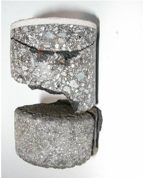
Abbildung 14: Bohrkern mit Teerplatte (unten), Gussasphalt (mitte) und Teppichboden (oben)
