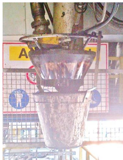
Abbildung 12: Abfüllstutzen mit Eimer unter der Oxidationsblase und leere Eimer zum Auffangen von Tropfverlusten
