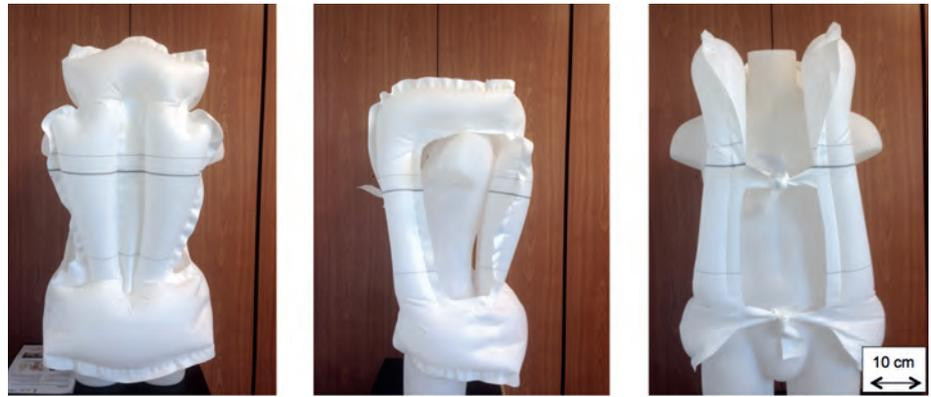
Abb. 2: 3D-One-piece-woven Airbag, (v. l. n. r.) Rück-, Seiten- und Frontansicht
