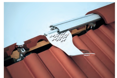
Abb. 8: Schienen am First ermöglichen eine Sicherung unter Einsatz von PSA über einen Großteil der Steildachfläche. Weitere Informationen zum Sicherheitsfirst-System auf Seite 54 in BauPortal 2/2017 (Foto: Braas)
