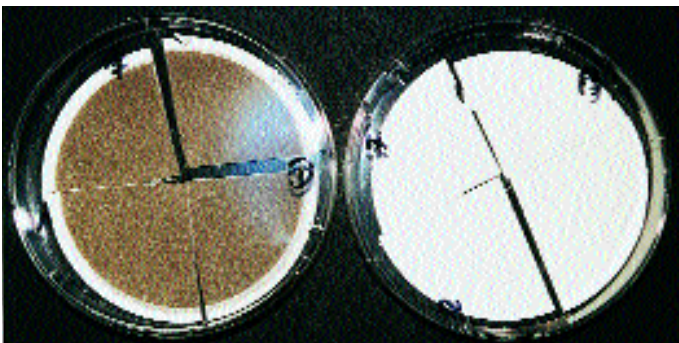
Abb. 6: Die für die Probenahmen verwendeten Gelatinefilter. Rechts ist ein nicht benutztes Filter zu sehen, links eines, durch das während simulierter Arbeitsaktivitäten in Kaiserslautern 1 m 3 Luft gesaugt wurde
