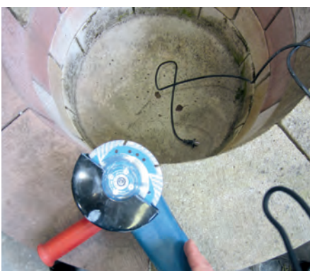
Abb. 3: Arbeitsaufgabe: Bearbeitung von innen; ein Führungsschlitten an der Maschine wäre hinderlich. Für die optimale Absaugung sollte die Absaughaube höhenverstellbar sein
