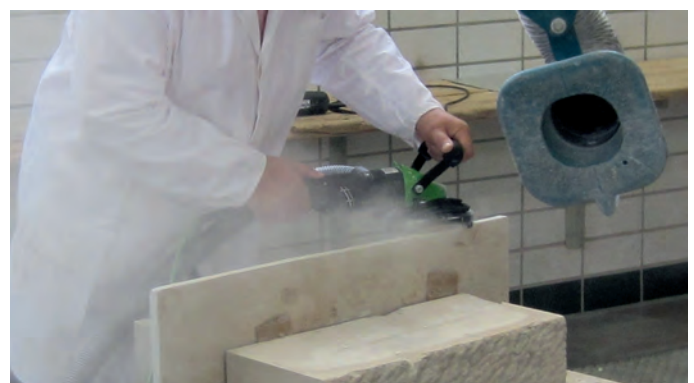
Abb. 4: Kantenbearbeitung bei nicht flächig aufliegender Schutzhaube mit abgesaugter Handmaschine (Fotos: W. Gunreben)
