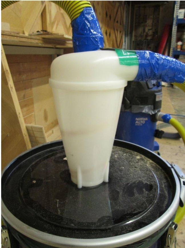
Bild 3: Zyklonvorabscheider im Praxistest. Deutlich erkennbar sind die Staubschlieren, die nach unten in den Behälter laufen. (Foto: BG BAU, Gunreben)
