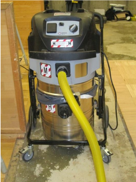
Bild 2: Mit dem Zentralverband Parkett und Fußbodentechnik wurde ein von Nilfisk bereitgestellter Entstauber, in leicht modifizierter Form, erfolgreich für die Absaugung von Parkettschleifmaschinen getestet. (Foto: BG BAU, Gunreben)
