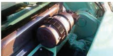
Die neue Zyklon-Vorfilteranlage für die KMC-Modelle von Kiesel (Foto: Kiesel)
