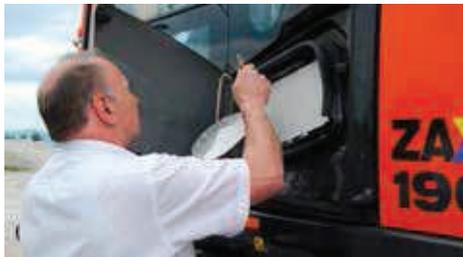
Staubtest an Kabinenzuluftfiltern bei Kiesel im vergangenen Jahr: Bestäubung der Filter mit einem Teststaub (Foto: DA)
