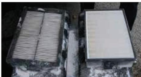
Das Standard-Filterelement (links) und der verbesserte Prototyp nach den Staubtests im Vergleich (Foto: DA)
