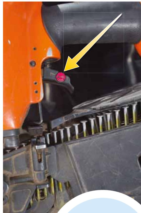
**Oben:** Auslösesicherung und Nagelmagazin als Coil.
