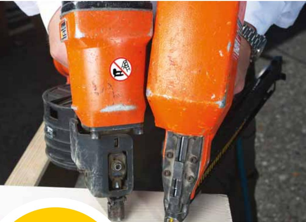
Links: Eintreibgerät mit wahlweiser Auslösung (umschaltbar) und Verwendungseinschränkung.
