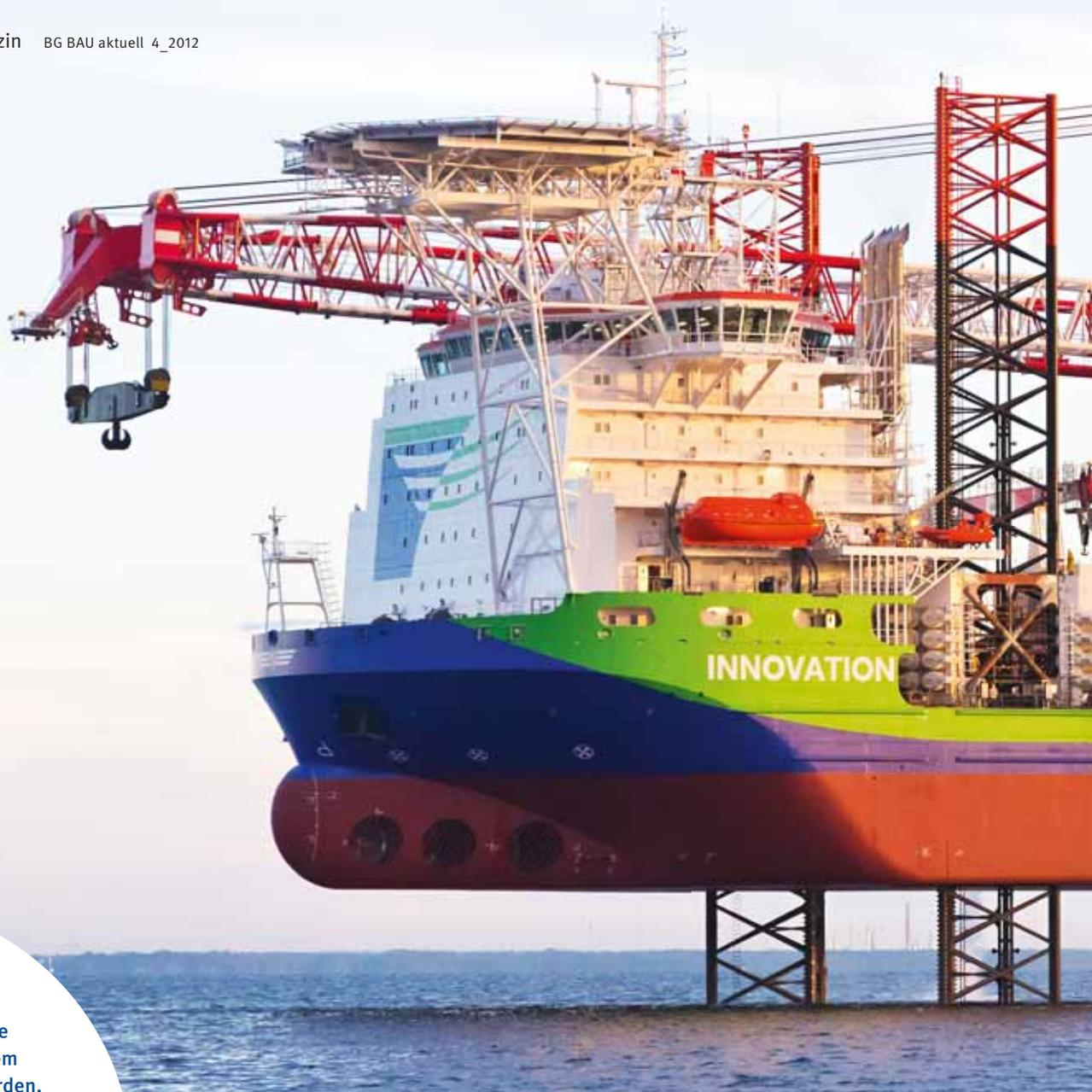
Das 147 Meter lange Schiff wurde aufgebockt: Jetzt können die Windkraftanlagen mit dem Schiffskran montiert werden.
