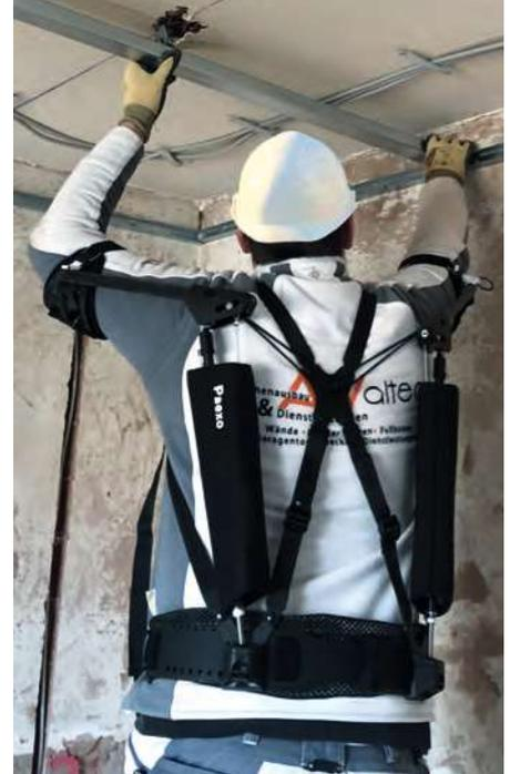
Mit einer mechanischen Seilzugtechnik wird das Gewicht der erhobenen Arme auf die Hüfte abgeleitet. So werden Muskeln und Gelenke im Schulterbereich geschont. Paexo ist ein passives Exoskelett, das keine Energiezufuhr benötigt und deshalb besonders leicht ist. Es wird eng am Körper getragen, ähnlich wie ein Rucksack, und ermöglicht dabei volle Bewegungsfreiheit
