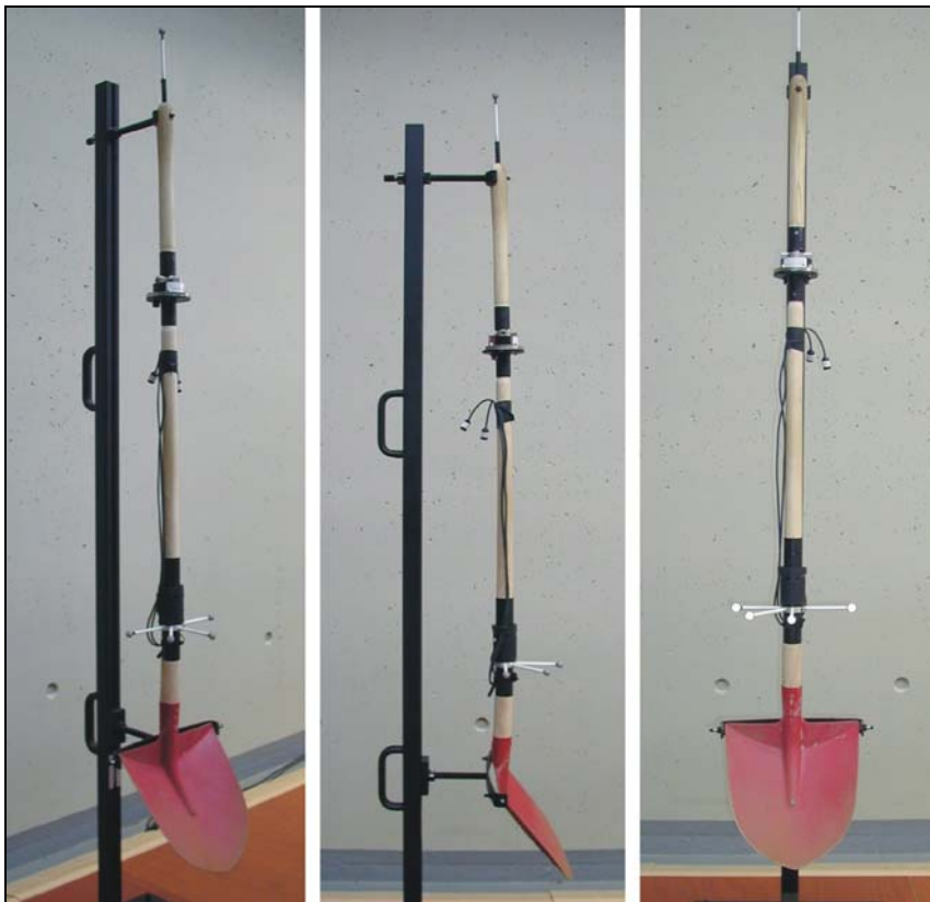
Abbildung 2.12: Mit Sensoren präparierte Messschaufel aus drei Perspektiven
