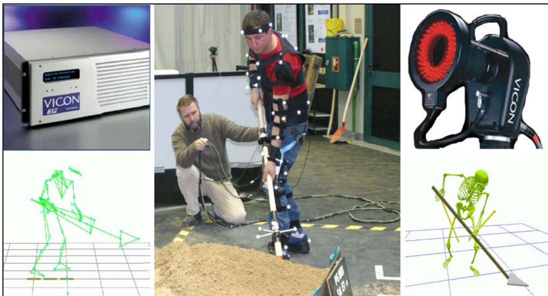
Abbildung 2.6: Opto-elektronisches Bewegungsmesssystem VICON zur Analyse dreidimensionaler Bewegungsabläufe
