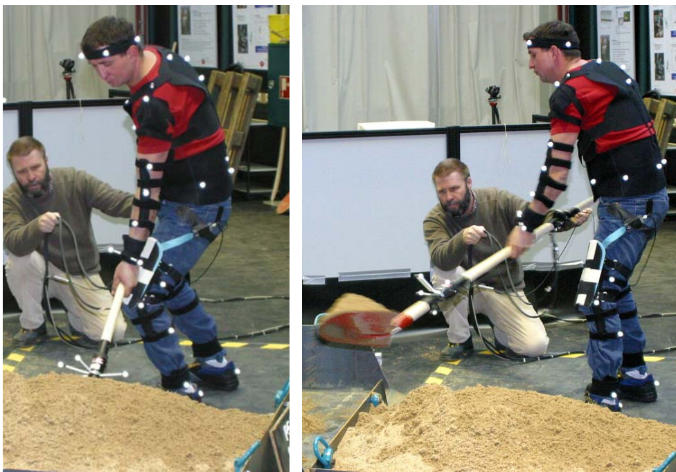
Abbildung 3.6: Schaufeltechnik „nach vorne“ (vom Bauch weg) von Proband 5; links: Einstich; rechts: Abwurf
