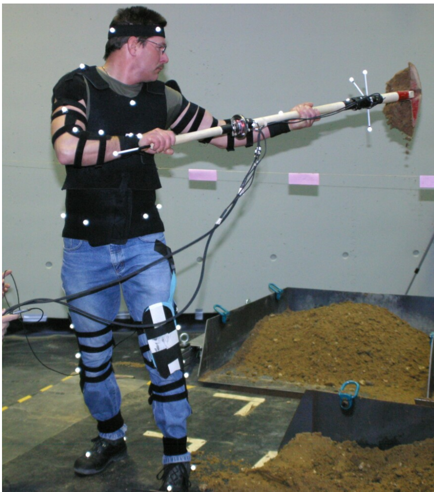
Abbildung 2.7: Mit reflektierenden Marken bestückte Versuchsperson beim Schaufeln mit der Messschaufel; hier Messkonstellation „Kies, nach oben, kurze Distanz“
