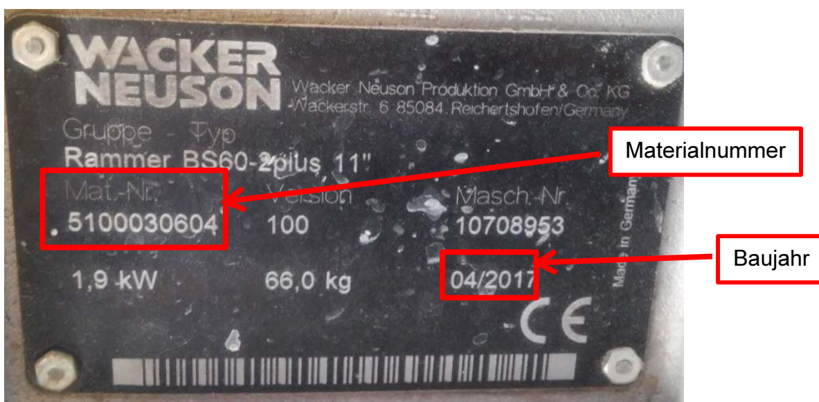
Abb. 3: Typenschild von einem neuen Stampfer. Die Material-Nummer beginnt mit 51000. Dieses Gerät kann im Graben eingesetzt werden.
