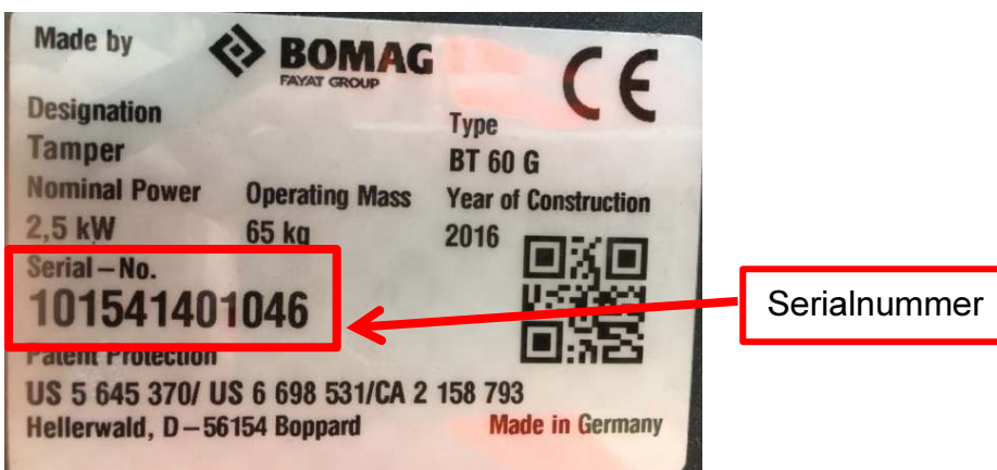
Abb. 2: Typenschild von einem Stampfer
