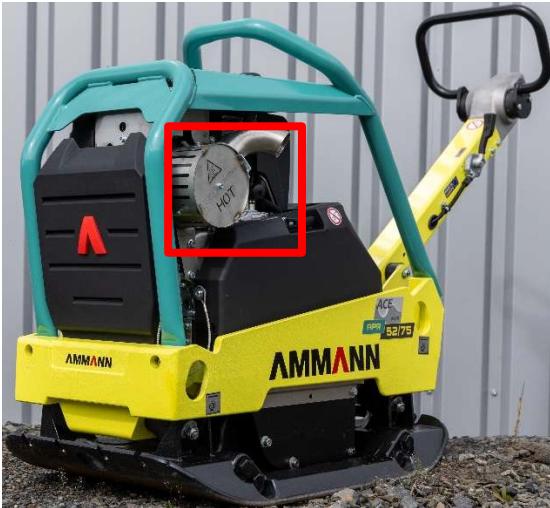
Abb. 12: Rüttelplatte mit Dieselpartikelfilter
