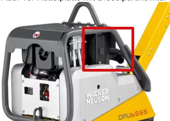
Abb. 11: Rüttelplatte ohne Dieselpartikelfilter
