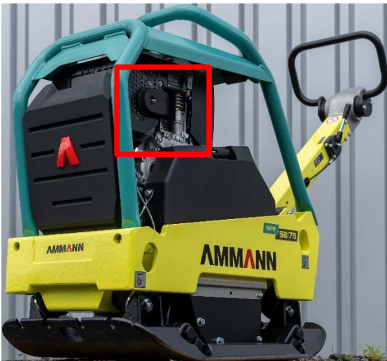
Abb. 13: Rüttelplatte ohne Dieselpartikelfilter
