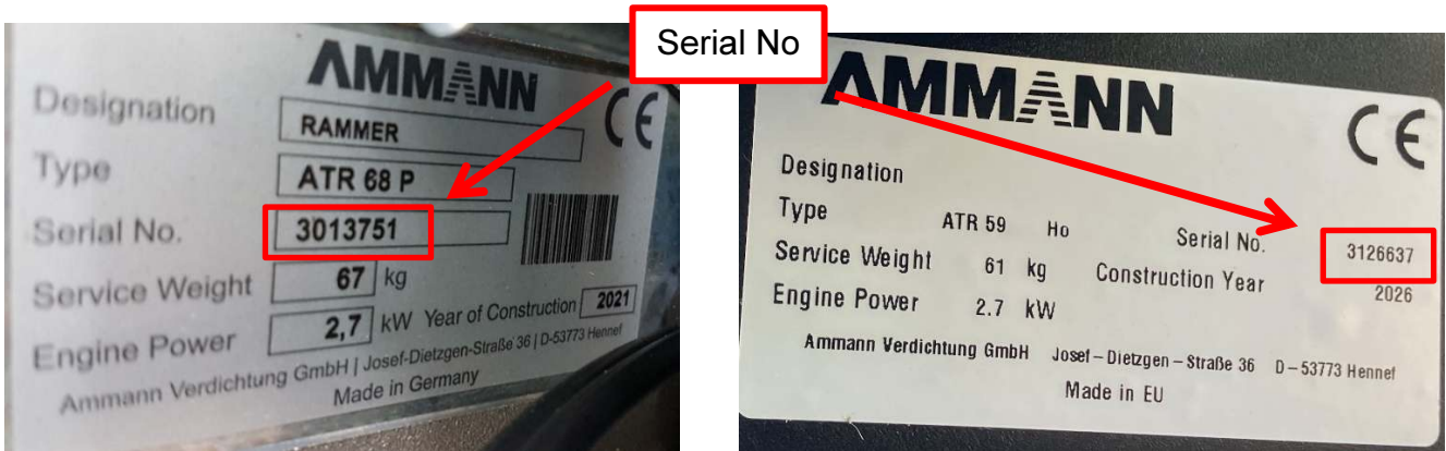
Abb. 1: Typenschilder von Stampfern
