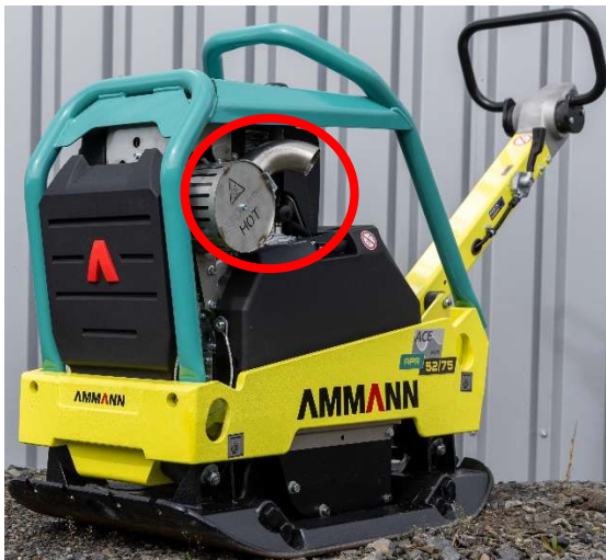
Abb. 12: Rüttelplatte mit Dieselpartikelfilter
