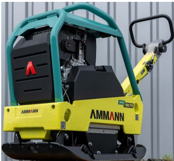
Abb. 13: Rüttelplatte ohne Dieselpartikelfilter
