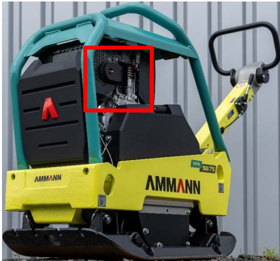
Abb. 13: Rüttelplatte ohne Dieselpartikelfilter
