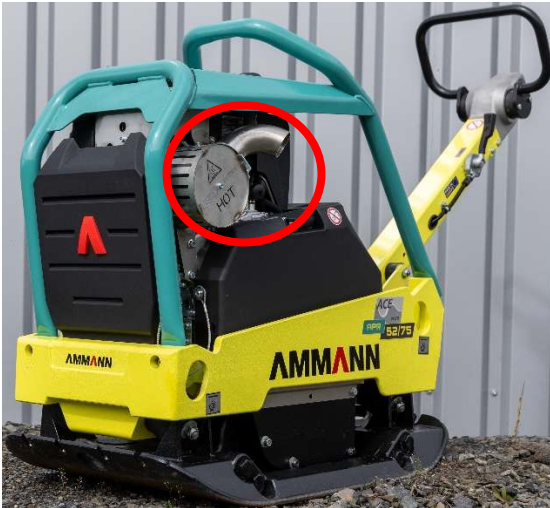
Abb. 12: Rüttelplatte mit Dieselpartikelfilter
