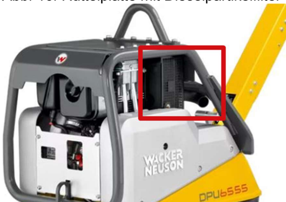
Abb. 11: Rüttelplatte ohne Dieselpartikelfilter
