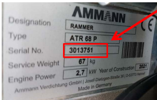
Abb. 1: Typenschilder von Stampfern
