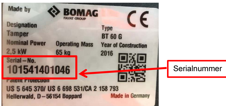
Abb. 2: Typenschild von einem Stampfer
