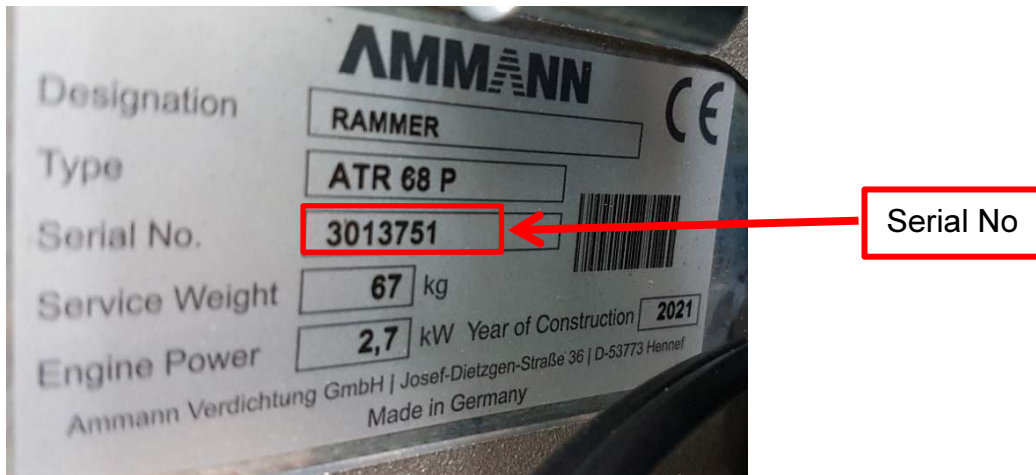
Abb. 1: Typenschild von einem Stampfer
