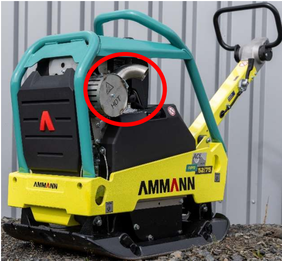
Abb. 12: Rüttelplatte mit Dieselpartikelfilter
