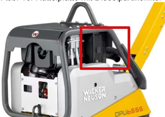
Abb. 11: Rüttelplatte ohne Dieselpartikelfilter
