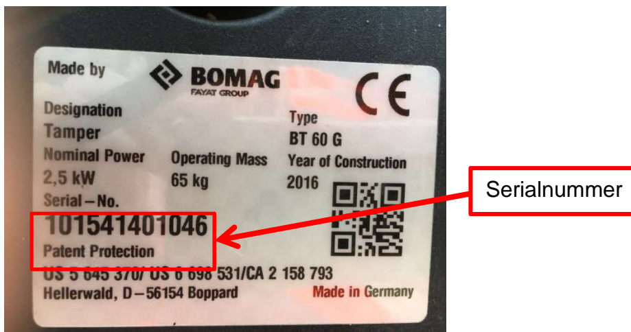
Abb. Typenschild von einem Stampfer
