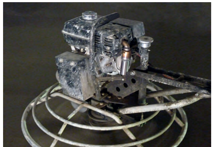
Abb. 2: Benzinbetriebener Glätter mit Katalysator
