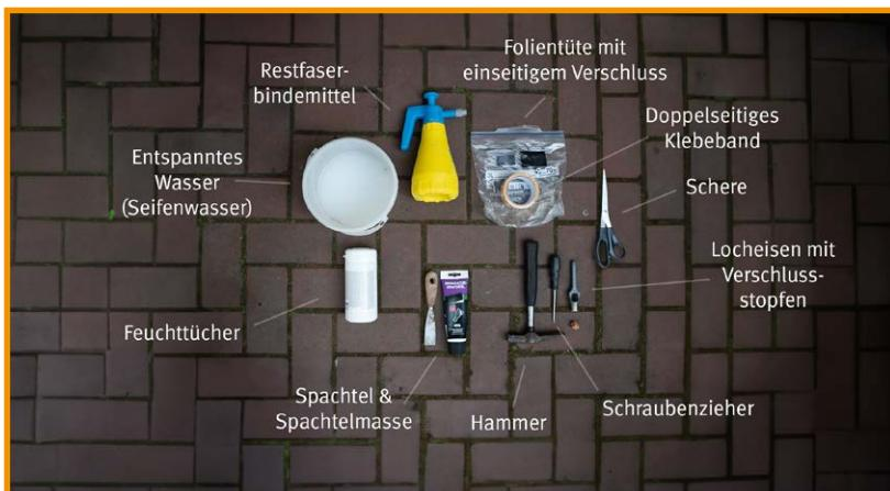
2 **Ausrüstung zusammenstellen:** Zentrale Elemente sind Locheisen und Stanzschleuse (fertig kaufen oder selbst anfertigen).
