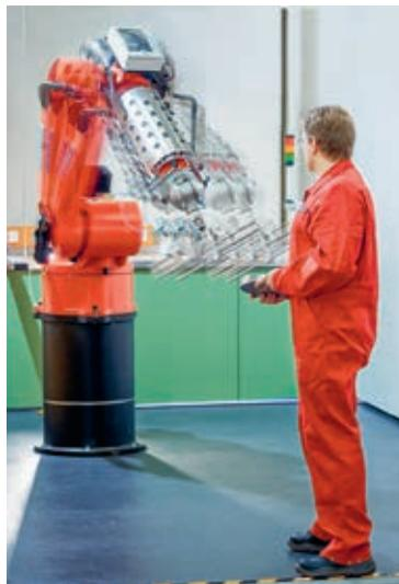
Prozesse, bei denen Menschen Hand in Hand ohne trennende Schutz-einrichtungen mit Industrierobotern zusammenarbeiten, müssen genau erforscht werden.
