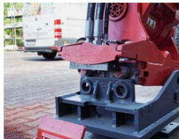
Der Maschinenführer verriegelt das System scheinbar, aber die Verriegelungsbolzen greifen nicht in die Aufnahmeklauen des Anbaugeräts, sondern darüber hinweg. Er bekommt das von seinem Bedienstand aus nicht mit.
