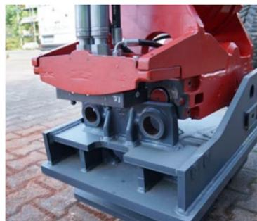
Auch in diesem Fall löst der Maschinenführer die Verriegelung korrekt aus. Doch die Verriegelungsbolzen schieben nicht in die Aufnahmeklauen, sondern blockieren an deren Umrahmung. Durch die geringen Gegenkräfte der Bolzen entsteht eine instabile Klemmverbindung, die kurzfristig trägt, aber bei Belastung nicht standhält.
