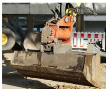
Der Maschinenführer vergisst zu verriegeln. Das passiert, wenn er abgelenkt wird oder seine Arbeit unterbrechen muss.
