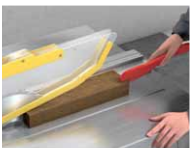
Die transparente, selbsttätig schließende Schutzhaube der Baustellenkreissäge ermöglicht eine gute Sicht auf die Schnittstelle.
