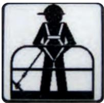
Abb. 2: Absturzschutz-ausrüstungen, die mit diesem Piktogramm gekennzeichnet sind, eignen sich für die Anwendung in Hubarbeitsbühnen (Foto: Schäper)
