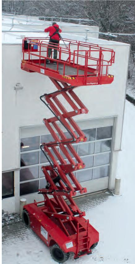
Abb. 5: Die Betriebsanweisung des Unternehmers oder eine Baustellenordnung können den Einsatz von PSA gegen Absturz auch auf Scherenbühnen erforderlich machen (Foto: Hahne)
