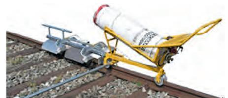
Auflagen zu beachten. Durch eine entsprechende Berücksichtigung im Arbeitsablauf kann das Hydraulikaggregat ggf. vor dem Tunnelmund positioniert werden (Schlusserschweißung vor dem Tunnel). Bei der Verwendung von Handpumpen entstehen keine Gefahrstoffe; neueste Geräte am Markt lassen einen wirtschaftlichen Einsatz von Handpumpen erwarten.
