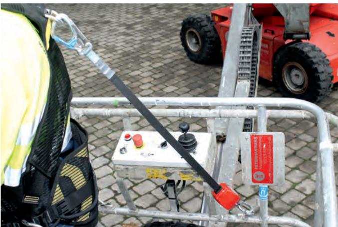
Abb. 4: Verbindungsmittel ohne falldämpfendes Element entsprechen nicht dem Stand der Technik und dürfen nicht mehr verwendet werden; auch der Anschlagpunkt im Arbeitskorb entspricht nicht den aktuellen Normvorgaben (Foto: Hahne)
