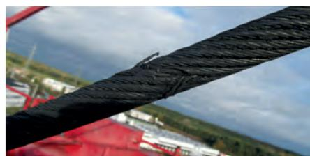
Abb. 4: Anriss am Fahrzeugkran
