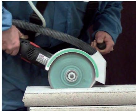
Abb. 3: Maschine mit staubreduzierender Absaugung von Galeski (Foto: BG BAU)
