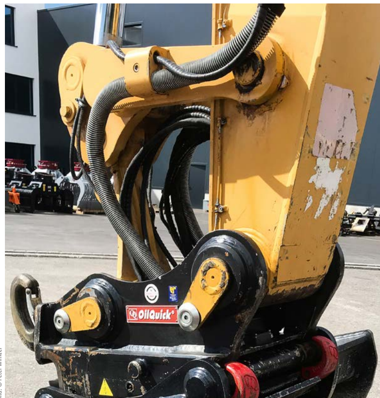
Mechanische Sicherung an der Aufnahmeachse durch Ausformung der Klaue
