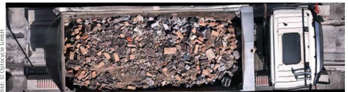
Beispiel für eine Lkw-Ladung mit Bauschutt, die gescannt wird
