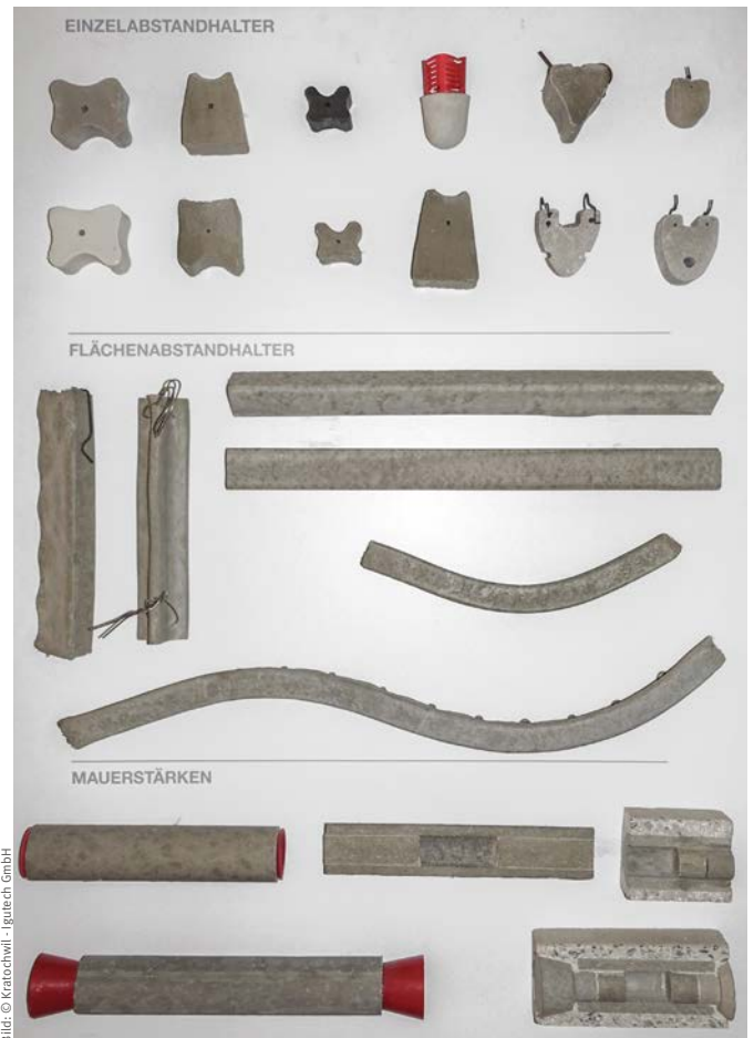
Übersicht über gängige Abstandshalter aus Asbest
