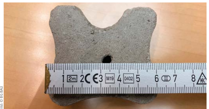
Abmessungen eines Abstandshalters
