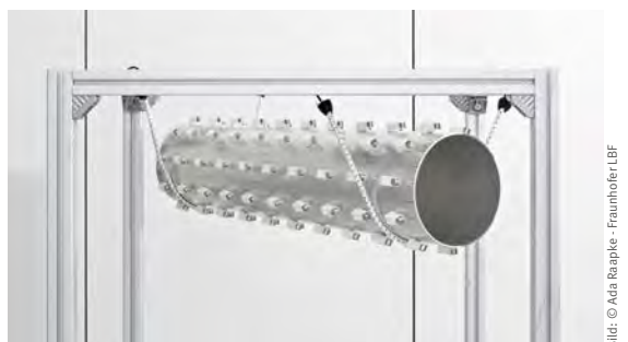
Beispiel für vibroakustische Metamaterialien: Rohr mit Resonatoren
