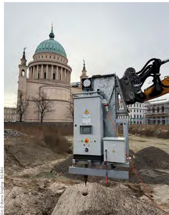
Auf dem Versuchsfeld am Block III wurde die Bohrlochstopfmaschine an einem Bagger angebracht.
