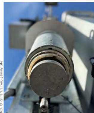
Stahl-Stopfkolben, der den Dichtbaustoff verdichtet
