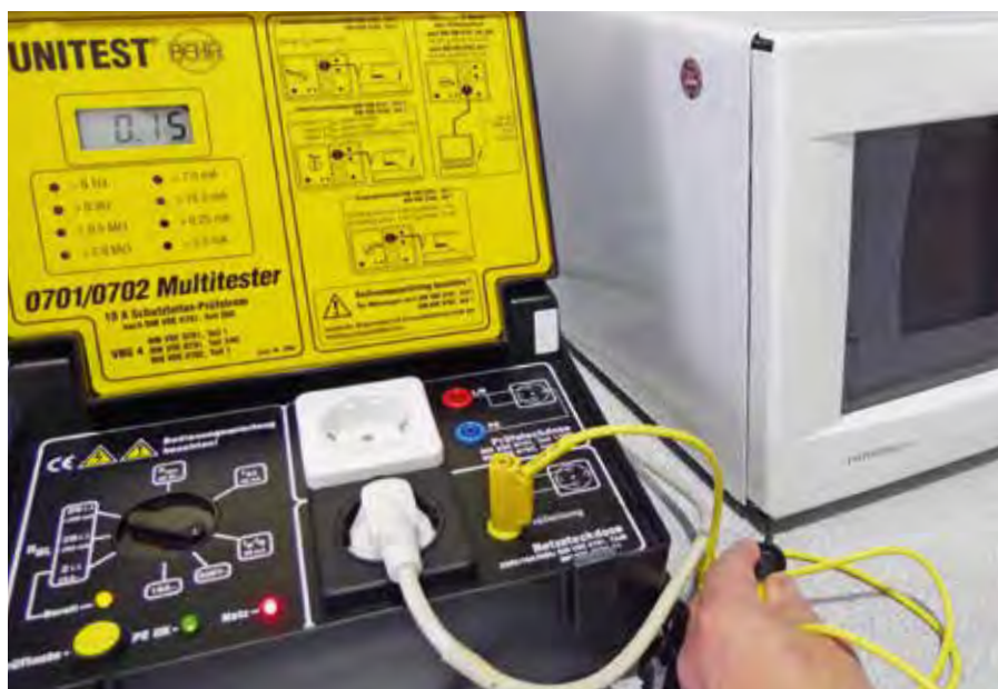
Prüfung elektrischer Betriebsmittel
