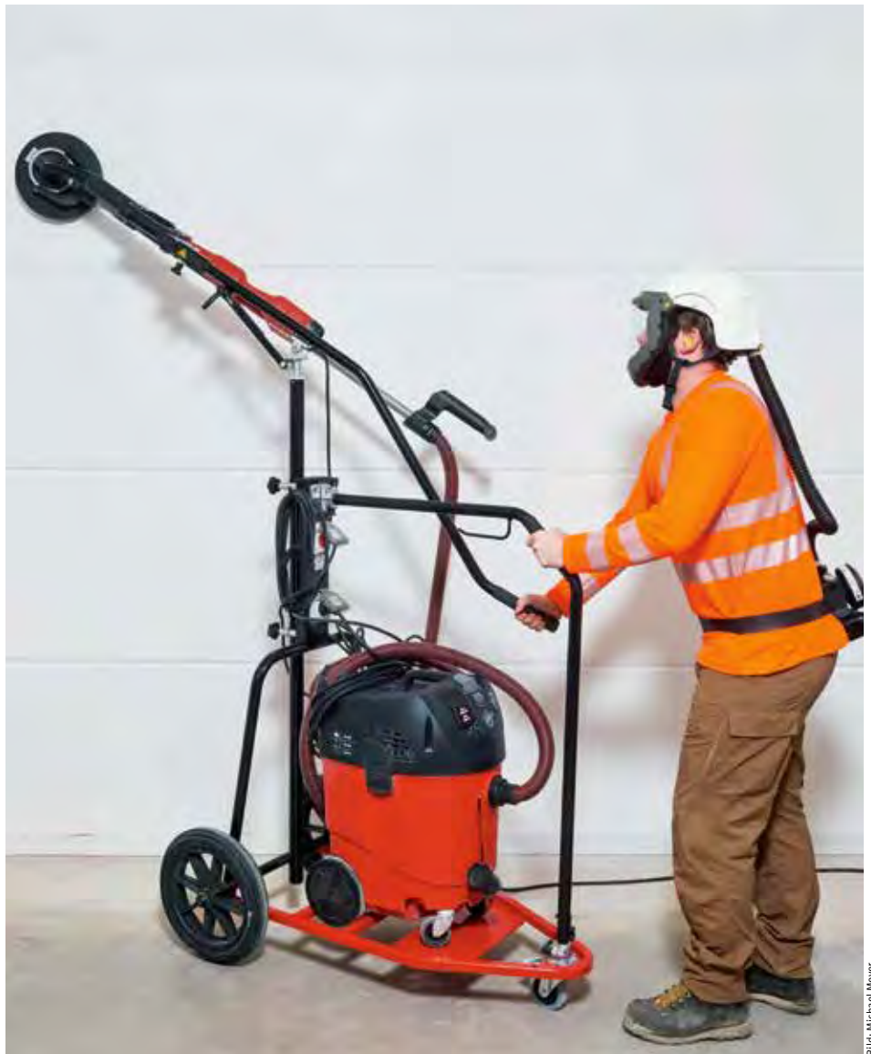
Abb. 1 · Bei Überkopfarbeit mit Langhalsschleifern kann ein Führungswagen Belastungen für Schultern, Arme und Rücken effektiv reduzieren.
