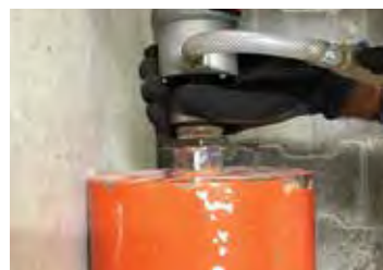
Der PQ6-Anschluss wird mit der Hand festgezogen und gelöst.
