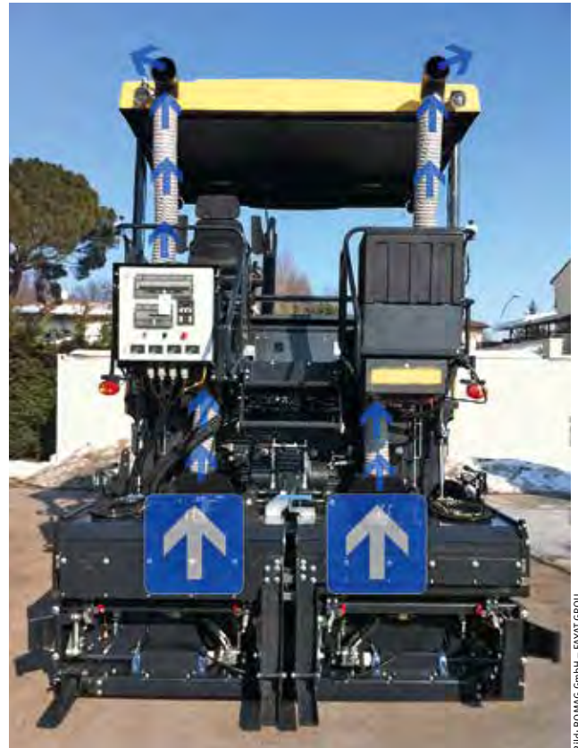
Abb. 4 · Beispiel eines Asphaltfertigers mit Absaugung, Luftführung der Absaugung hervorgehoben
