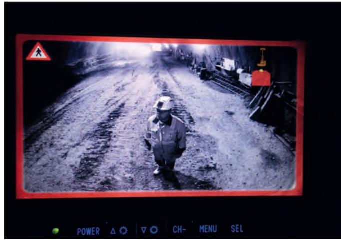
Abb. 3: Fußgängererkennung des Systems Blaxtair mit optischer Warnanzeige in der Fahrerkabine
