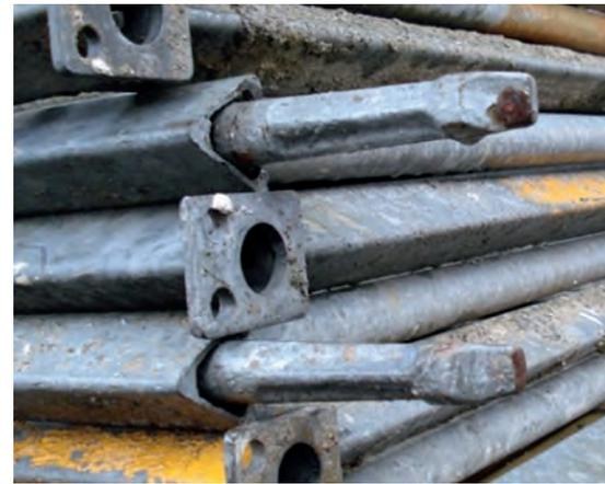
Abb. 2: Gerüstsystem mit dreieckigem Rahmenquerschnitt
