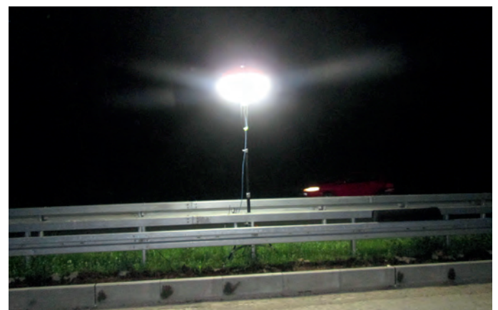
Abb. 10: Leuchtballon mit einer Leistung von 2.000 Watt für Halogenlampen
