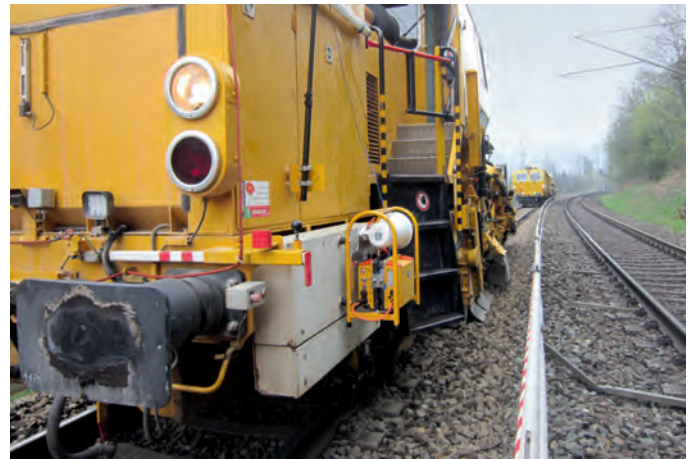
Abb. 4: Um den Spalt zwischen FA und Maschine vor einer Zugfahrt im Nachbargleis räumen zu können, erhalten GSM (links) und SSP (rechts) funkgesteuerte Warnsignalgeber – dabei muss die Fahrzeugbegrenzungslinie beachtet werden
