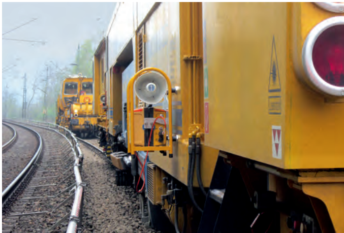
Abb. 4: Um den Spalt zwischen FA und Maschine vor einer Zugfahrt im Nachbargleis räumen zu können, erhalten GSM (links) und SSP (rechts) funkgesteuerte Warnsignalgeber – dabei muss die Fahrzeugbegrenzungslinie beachtet werden
