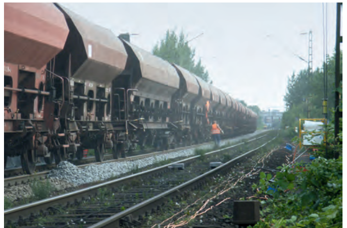
Abb. 4: Um den Spalt zwischen FA und Maschine vor einer Zugfahrt im Nachbargleis räumen zu können, erhalten GSM (links) und SSP (rechts) funkgesteuerte Warnsignalgeber – dabei muss die Fahrzeugbegrenzungslinie beachtet werden
