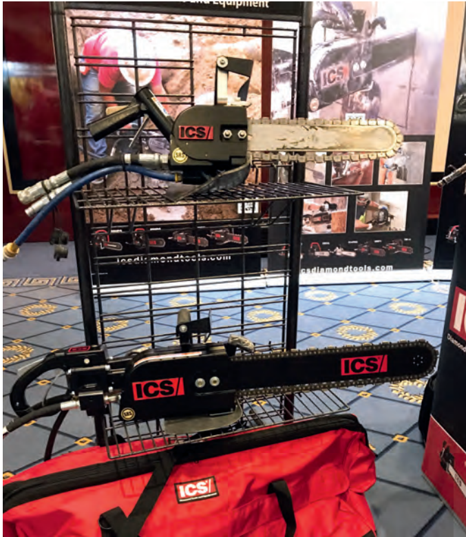
Diamantsägen für Beton mit Verbrennungsmotor, Hydraulik- oder Druckluftanschluss zeigte die Firma ICS aus Belgien
