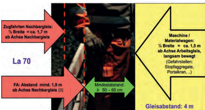
Abb. 6: Die Maschinen, bei denen mit dem Aufenthalt zwischen Maschine und FA gerechnet werden muss (GSM, SSP, ZWB), werden mit funkgesteuerten Warnsignalgebern besetzt – die „Räumzeit“ zum Verlassen dieses Bereichs vor einer Zugfahrt im Nachbargleis wird bei der Projektierung der ATWS berücksichtigt
