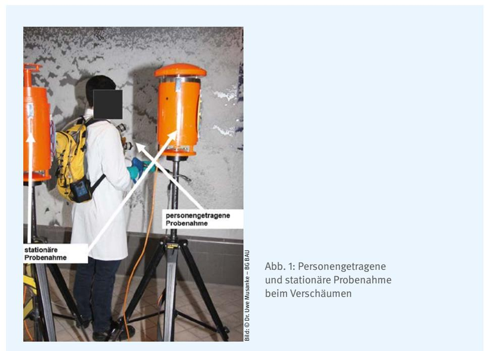
Abb. 1: Personengetragene und stationäre Probenahme beim Verschäumen
