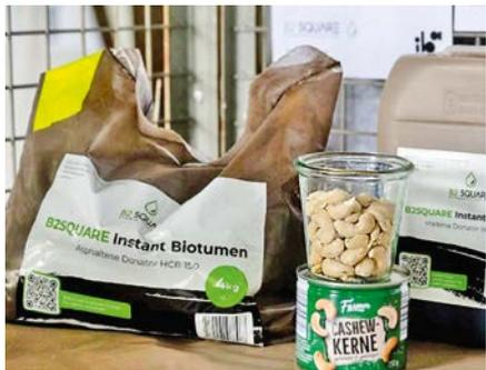
Das von B2Square hergestellte Biobitumen enthält u. a. ein Extrakt aus gepressten Cashewnusschalen.
