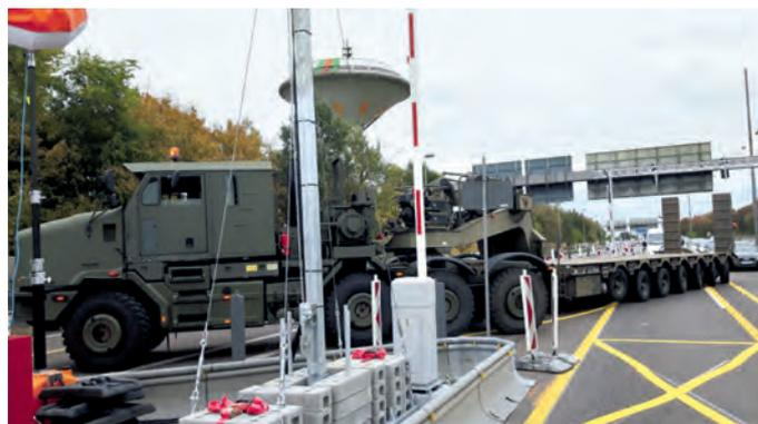
Fahrbahn eingelassene Bodenwaage bestimmt. Deshalb gilt vor der Schrankenanlage auf eine Geschwindigkeitsbeschränkung von 40 km/h. Wird dabei ein Gewicht von über 3,5 t festgestellt, senken sich automatisch die Schranken und die Ampeln schalten auf Rot. Der Lkw kann dann seitlich auf eine Spur, die von der Brücke wegführt, abgeleitet werden.
