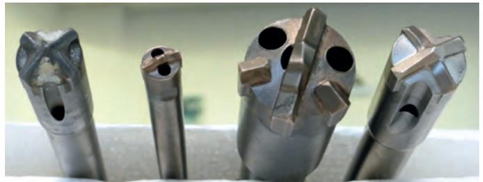
Herkömmliche Bohrer haben eine Bohrwendel zur Förderung des Bohrstaubes aus dem Loch heraus. Absaugbohrer haben im Gegensatz dazu einen weitgehend glatten Zylinderschaft und Öffnungen an der Spitze, durch die der Staub über eine im hinteren Teil des Bohrers angebrachte Kupplung und den daran angeschlossenen Bau-Entstauber abgesaugt wird (Abb. 9). Der Staub von Bohrlochern wird somit an der Entstehungsstelle entfernt.
