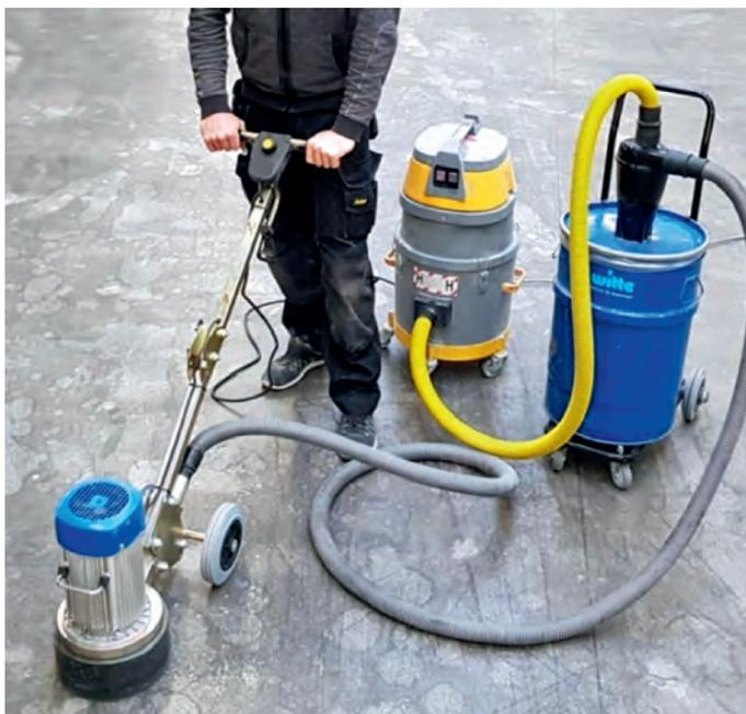
Abb. 8: Luftreiniger und Bau-Entstauber
