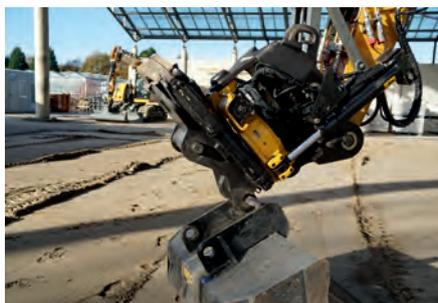
Abb. 2: Formschlüssige Schnellwechseleinrichtung, Verriegelungsbolzen in Querrichtung
