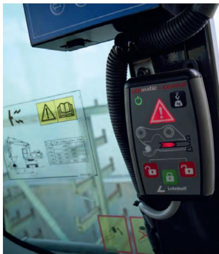
lungsbolzen ins Leere fahren (Ursachenszenario 2a) oder gegen den Querriegel bzw. die Seitenwand (Ursachenszenario 2b) drücken. In diesem Fall täuscht die Anzeige dem Fahrer eine korrekte Verriegelung vor. Eine falsche Anzeige kann auch durch einen defekten oder einen falsch eingestellten Druckmesser in der Schnellwechseinrichtung verursacht werden. Ist der Druck zu niedrig, kann das dazu führen, dass die Verriegelungsbolzen nicht weit genug ausgefahren werden.
