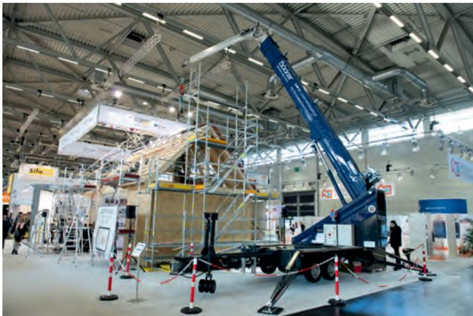
Abb. 3: Anhängerkran AHK 36 mit Personensicherungsmodus von Böcker (Foto: Matzke)
