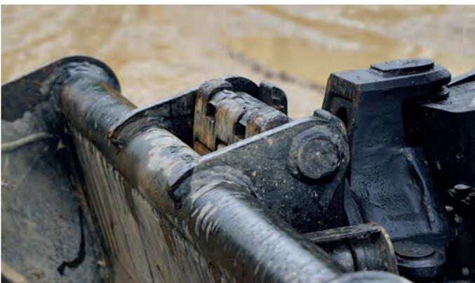
Abb. 12: Prüfung der Verriegelung durch Druck gegen den Boden
