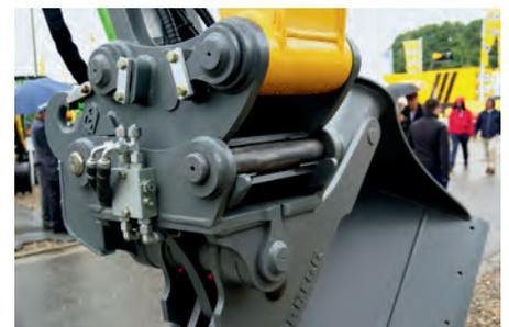
Abb. 4: Schnellwechsler gegen Anbaugerät gedrückt
