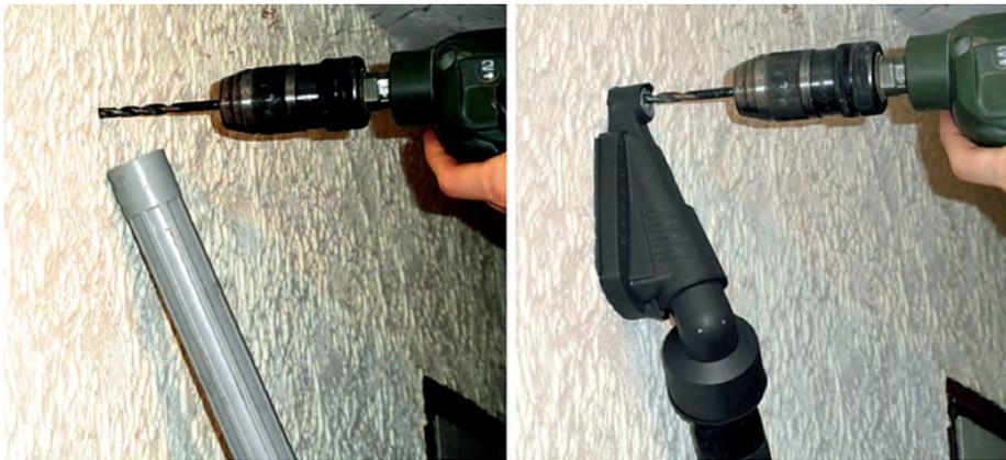
Abb. 10: Bohren ohne und mit Absauglocke
