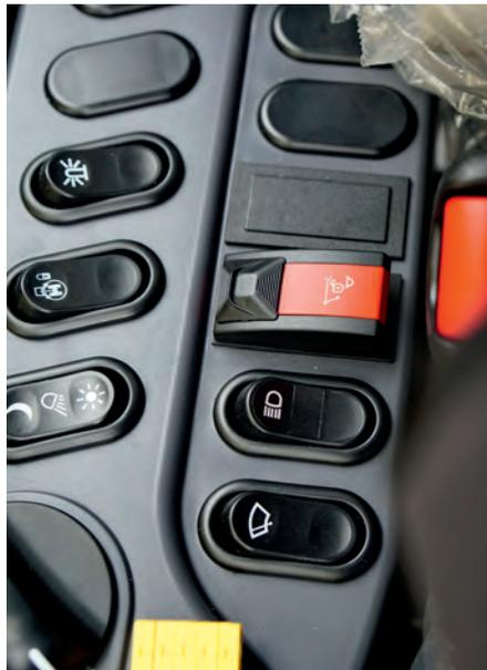
Abb. 9: Schutz gegen unbeabsichtigte Betätigung, Entriegelungssperre
