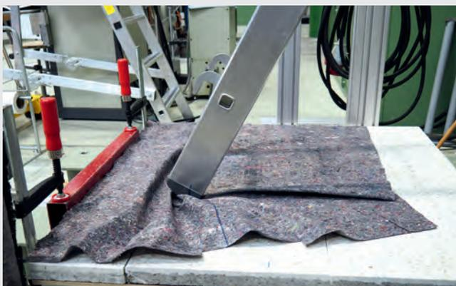
Im Labor nachgestellte Unfallsituation: Zu sehen ist die Abdeckung eines Betonsteinbodens mit einem Malerabdeckvlies, welches durch die Belastung der Anlegeleiter verrutschte (Video auf <http://www.dguv.de/fb-bauwesen/sachgebiete/hochbau/montage-ausbau/videos/index.jsp>)
