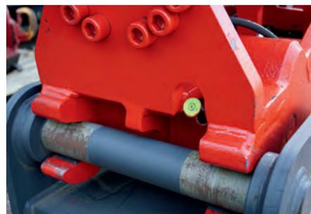
Abb. 8: Verriegelung nicht korrekt, Bolzen drücken gegen die Aufnahme
