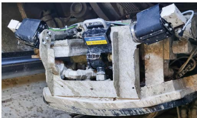
Abb. 3: Test automatischer Ringmontagesysteme in Schwanau: Vakuumsaugplatte eines Feldprototyps für die automatische Ringmontage an einem 3-m-EPB-Schild (links) und Versuchsanordnung einer 8-m-TBM (rechts)
