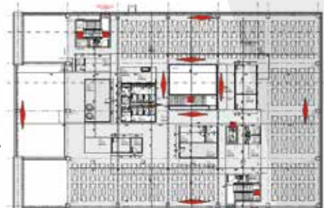
Darstellung der Absturzgefahren im 2D-Grundriss
