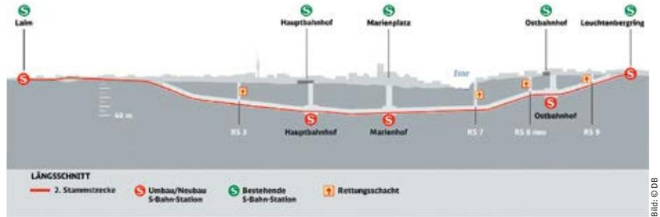
Abb. 1: Längsschnitt des betreffenden Streckenabschnitts
