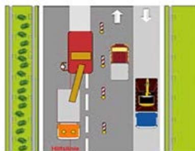
Abb. 4: Unterschiedliche Arbeitsverfahren: Die Hilfslinie (weitergezeichnete Fräskante an der linken Seite der Maschine) beim alternativen Arbeitsverfahren zeigt, dass sich das Personal im sicheren Bereich befindet.
