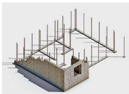
Stahlstäbe verleihen den Hauswänden Stabilität.
