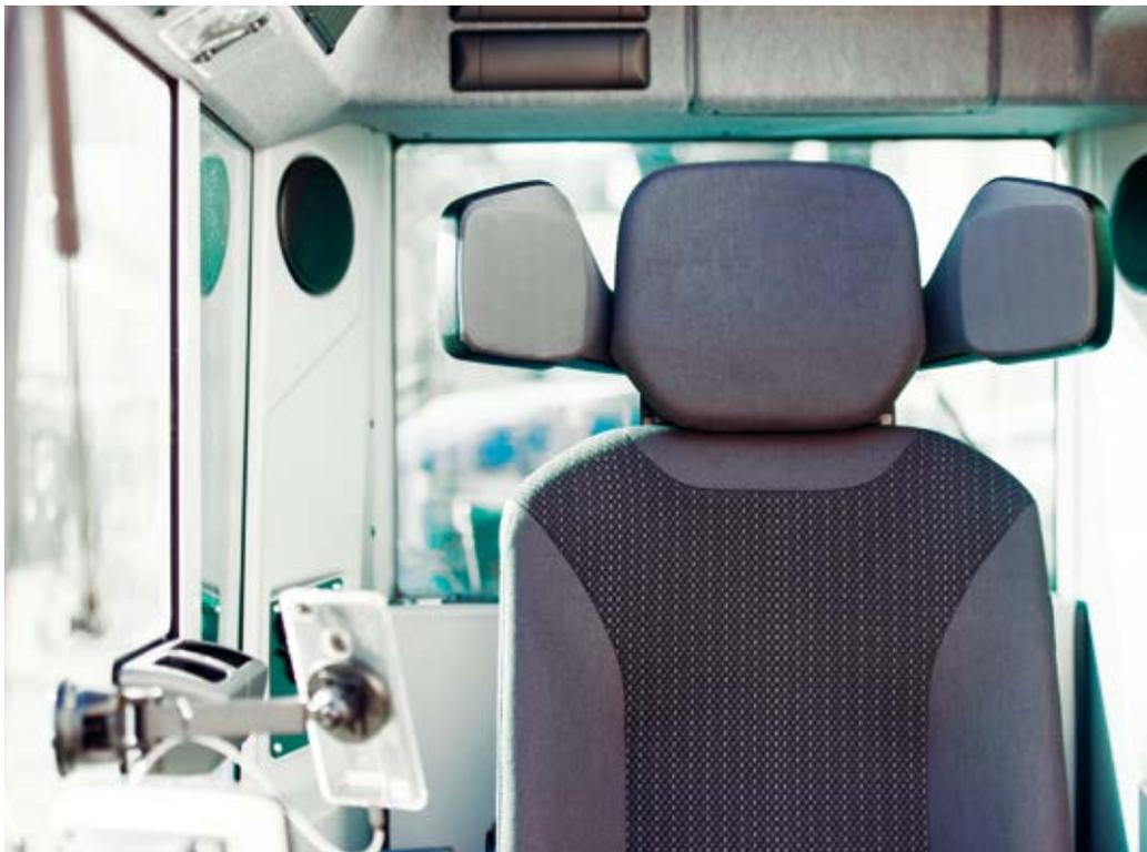
Aktive Lärmreduktion kann auf lange Sicht Lärmschwerhörigkeit oder sogar Hörverlust verhindern: Das Hamburger Start-up Recalm minimiert Lärm auf intelligente Weise – mit gezielt berechneten, genau ausgerichteten Schallwellen.
