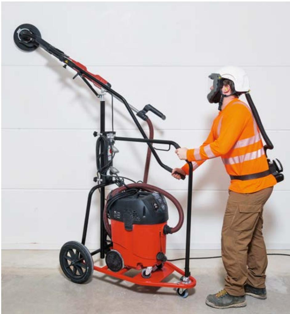
Mit dem Langhalsschleifer können Decken und Flächen in Höhen von 3 m ohne den Einsatz von Leitern oder Gerüsten erreicht werden.
