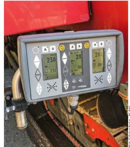
Abb. 2: Kontrollkonsole an einer Fräse im sicheren Arbeitsbereich auf der verkehrsabgewandten Seite
