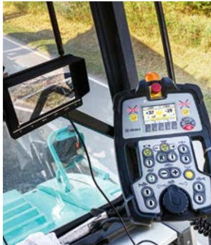
Abb. 5: Fertiger mit Kamera-Monitor-System im Führerstand, sicherer Arbeitsplatz zur Kontrolle des Einbauvorgangs
