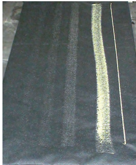
Abb. 5: Beispiel für einen Stoffprüfling, 250, 350, 500, 1.000 bar (jeweils Flachstrahldüse) und 500 bar Rundstrahldüse – der Stoffprüfling hat bei der Flachstrahldüse bis 1.000 bar bestanden und ist bei der Rundstrahldüse durchgefallen (Foto:Waldinger)
