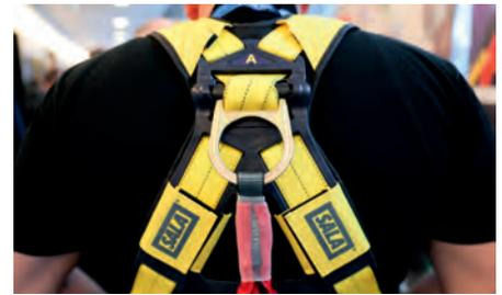
Abb. 20: Wichtiger Bestandteil einer persönlichen Schutzausrüstung gegen Absturz (PSAgA): ein Ganzkörperauffanggurt (Foto: Bauerlag BV)
