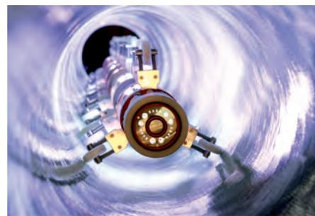
Sanierung mittels GFK-Schlauchliner, Lichtquelle 8 x 400 W in einem Liner DN 300 (Foto: BKP Berolina Polyester GmbH)
