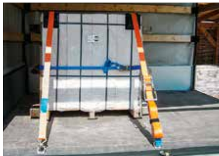
Abb. 7: Sicherung einer Palette mit Kalksandsteinen auf rutschhemmendem Material (RHM): Zurrpunkt Abstand 1 m
