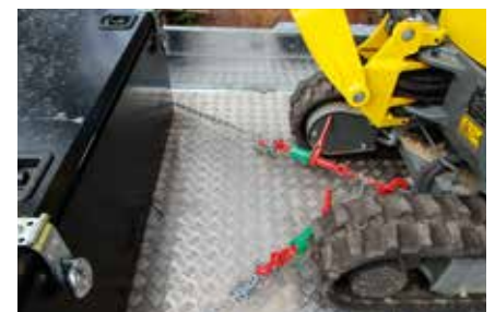
Abb. 3: Einfaches Diagonalzurren, Zurrmittel kreuzen sich nicht.
