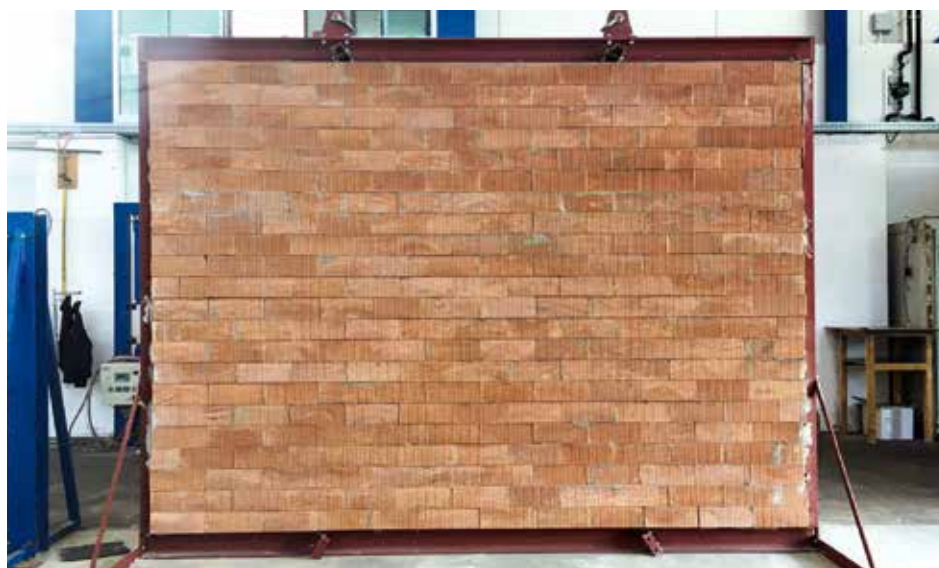
In aufwendigen Prüfverfahren wurde der Vollziegel-Prototyp hinsichtlich Druckfestigkeit, Rohdichte, Wärmespeicherfähigkeit, Schallschutz sowie Frost- und Taubeständigkeit getestet.
