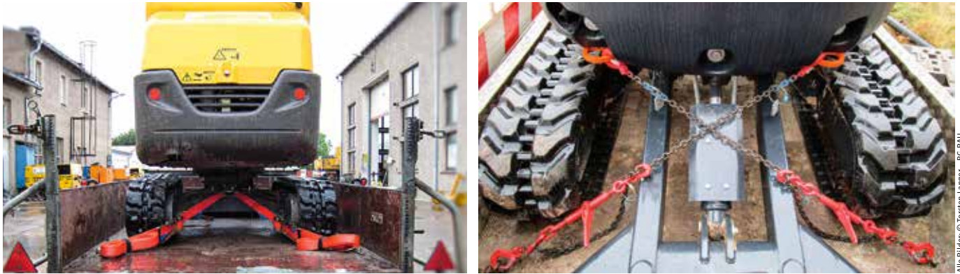
Abb. 5 und 6: Zurrwinkel ( \alpha ) unter 30^\circ bei der Verwendung der Zugöse am Unterwagen bzw. der Zurrpunkte am Heck des Oberwagens
