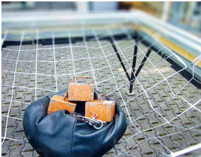
Prüfung nach GS-BAU-18: Prüfkörper mit Zusatzgewichten
