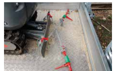
Abb. 4: Kreuzweises Diagonalzurren, Zurrmittel kreuzen sich.
