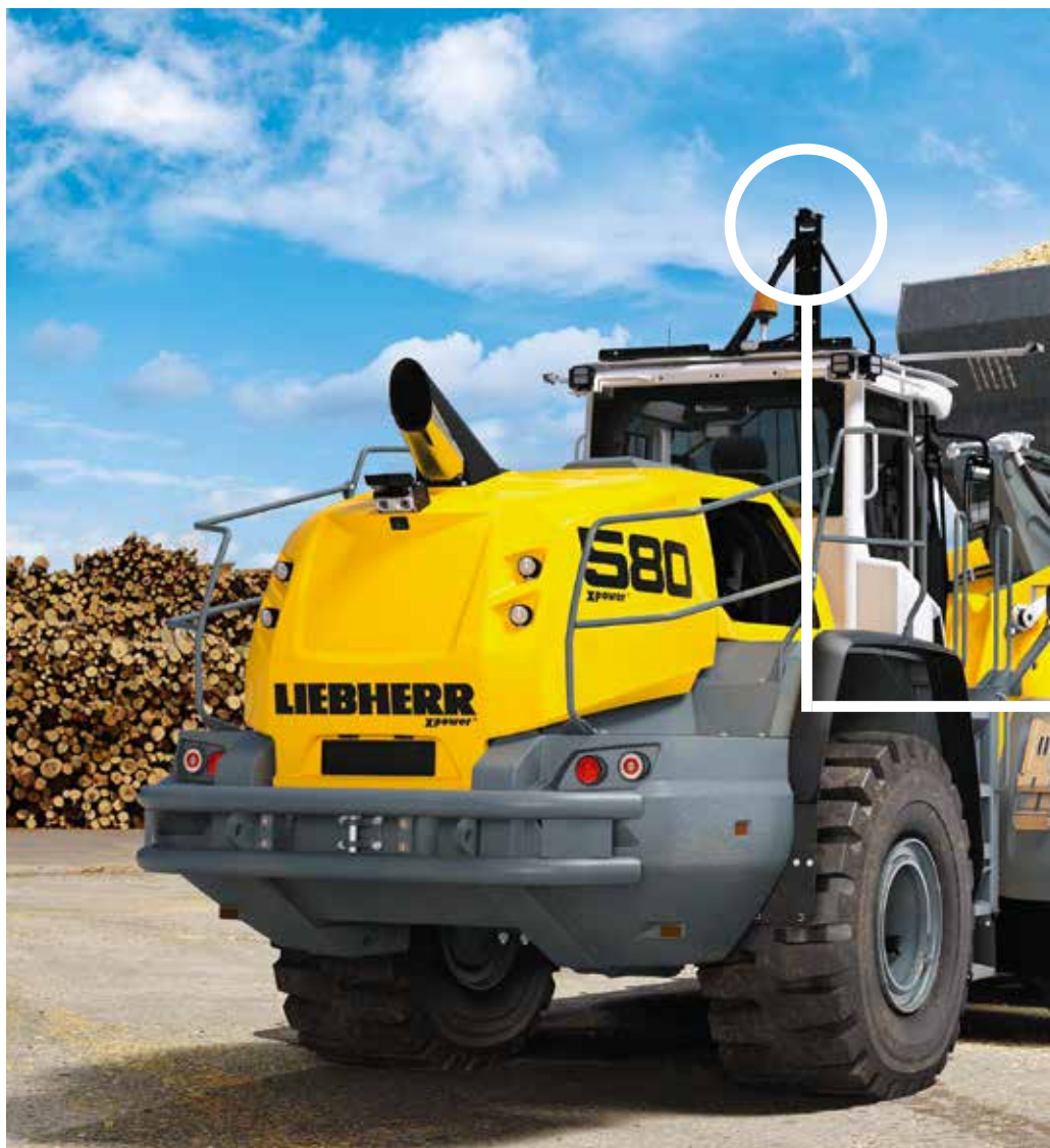
Für den Transport von Leichtgut werden Radlader mit großvolumigen Leichtgutschaufeln ausgerüstet. Für die bessere Sicht ist der Radlader mit einem Birdview-System ausgestattet.
