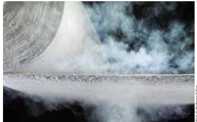
Abb. 2: Ein diffusionsoffenes Abdeckvlies lässt den Untergrund atmen und Restfeuchte kann entweichen.
