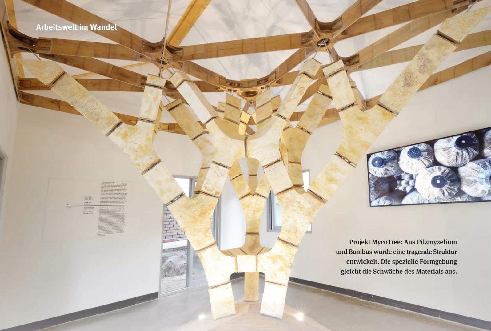
Projekt MycoTree: Aus Pilzmyzelium und Bambus wurde eine tragende Struktur entwickelt. Die spezielle Formgebung gleicht die Schwäche des Materials aus.
