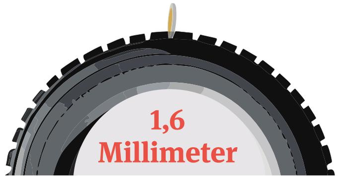
1,6 Millimeter beträgt die gesetzlich vorgeschriebene Mindestprofiltiefe. Expertinnen und Experten empfehlen für die Winterzeit sogar mindestens vier Millimeter für ausreichend Grip. Tipp: Der silberne Rand einer Zwei-Euro-Münze beträgt vier Millimeter. Wenn die Münze in die Mitte des Reifenprofils gesteckt wird und der Rand komplett verschwindet, ist man auf der sicheren Seite.
