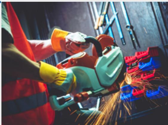
Trennschleifer, im allgemeinen Sprachgebrauch auch „Trennjäger“ genannt, dienen dazu, Materialien wie Beton, Metall oder Asphalt zu durchtrennen. Im Gegensatz zu mit Dieselmotor oder per Kabelanschluss betriebenen Maschinen sind Akku-Trennschleifer sicherer zu handhaben und vermeiden gesundheitsschädliche Abgase. **Wichtig:** Winkelschleifer werden nicht gefördert.
