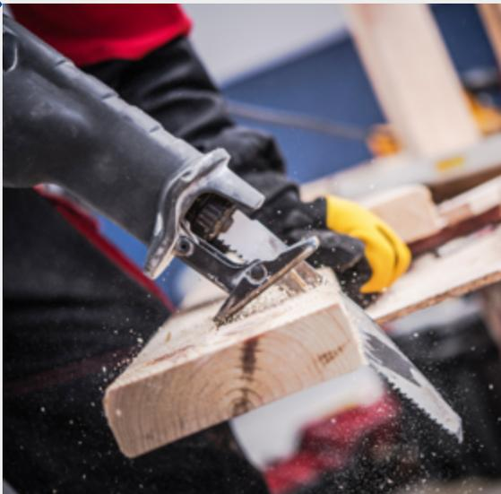
Ob Akku-Pendelsäbelsägen, Akku-Handkreissägen, elektrische und akkubetriebene Fuchsschwanzsägen – sie alle bieten eine hohe Schnittleistung, erlauben ergonomisches Arbeiten und sind vielseitig einsetzbar. Vor allem aber können Sie damit den Einsatz von Kettensägen vermeiden, die bei Unfällen zu schwersten Verletzungen führen können.
