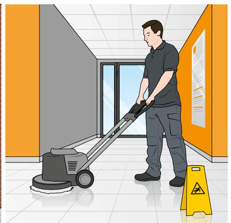
**Die (höhenverstellbare) Deichsel** der Einschei-benmaschine wird beidhändig in Leistenhöhe geführt.
