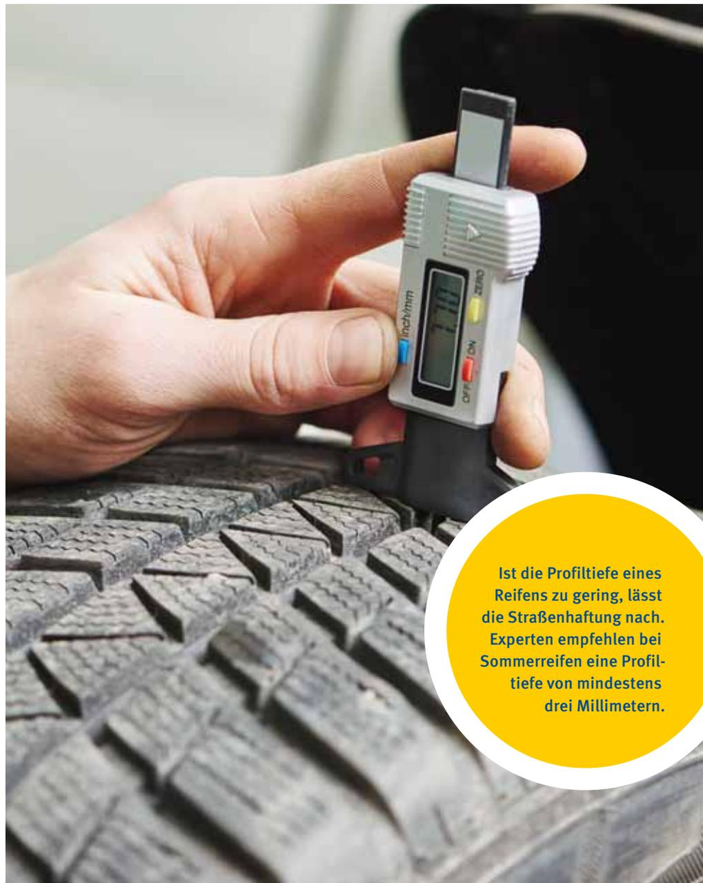
Ist die Profiltiefe eines Reifens zu gering, lässt die Straßenhaftung nach. Experten empfehlen bei Sommerreifen eine Profiltiefe von mindestens drei Millimetern.
